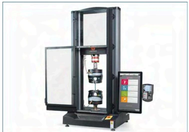
Figura 5. Máquina universal servo-hidráulica Instron 5960
