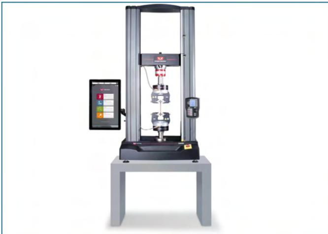
Figura 3. Máquina universal servo-hidráulica Instron 5960.
