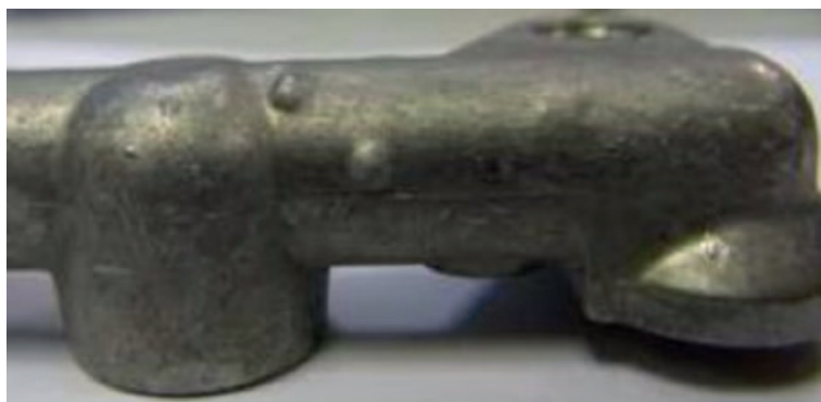
Figura 4. Ampollas formadas en piezas obtenidas por HPDC después del tratamiento de disolución y temple [3].
