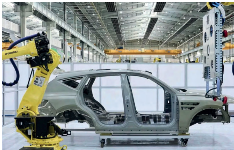
Figura 2. Chasis de un vehículo Hyundai producido mediante el método de hypercasting
